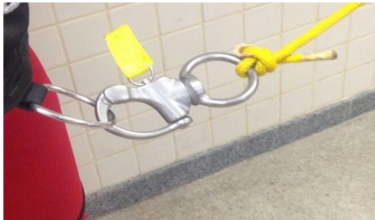
Figura 3.1 – Detalhe da ancoragem do mosquetão de segurança ao D'ring do CE
