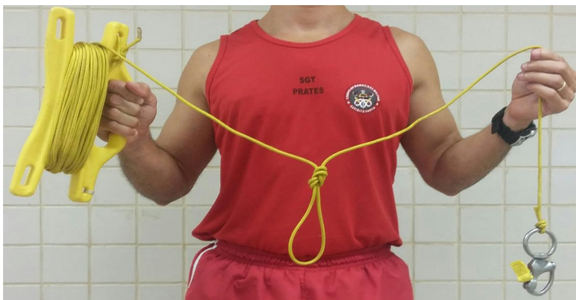
Figura 1 - Cabo guia com bitola de 04 mm, 100% em poliéster, flutuabilidade negativa, cor amarelo, com 30m de comprimento e carga de ruptura de 178 Kg/m. Acondicionado no Enrolador de cabos é ideal para os padrões de busca e recuperação subaquática do tipo Circular e Varredura em "U" com cabo guiado pela superfície (Arrasto), que exija o seu manuseio pelo Mergulhador de fundo ou Nadador guia de superfície.
